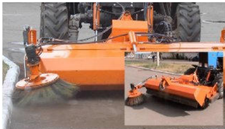
Рисунок 7.1. Щеточное оборудование на МТЗ ЩФС 2.0
