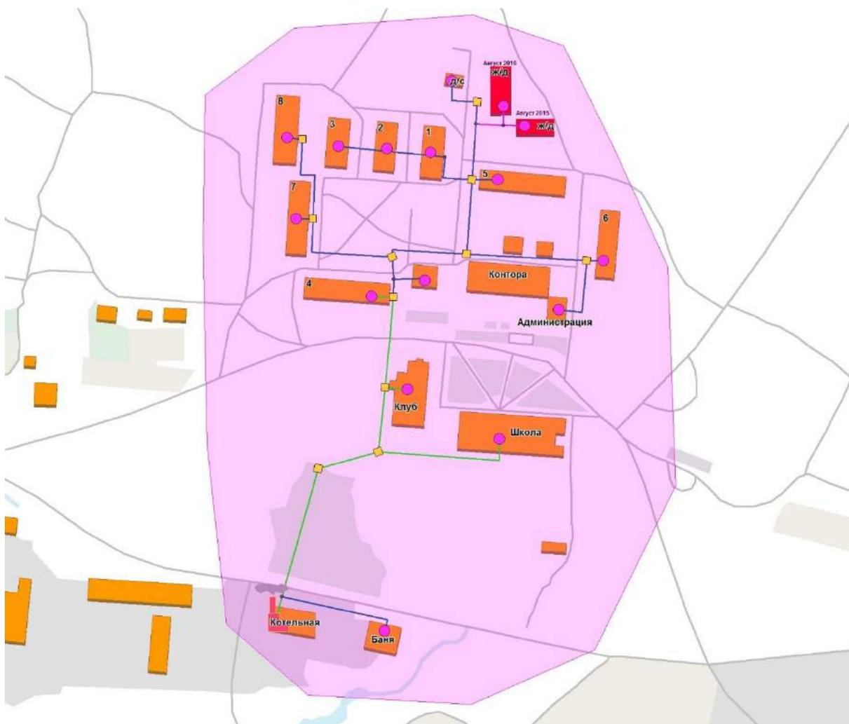
**Рисунок 2.2.2. – Зона действия котельной п. ст. Громово.**
