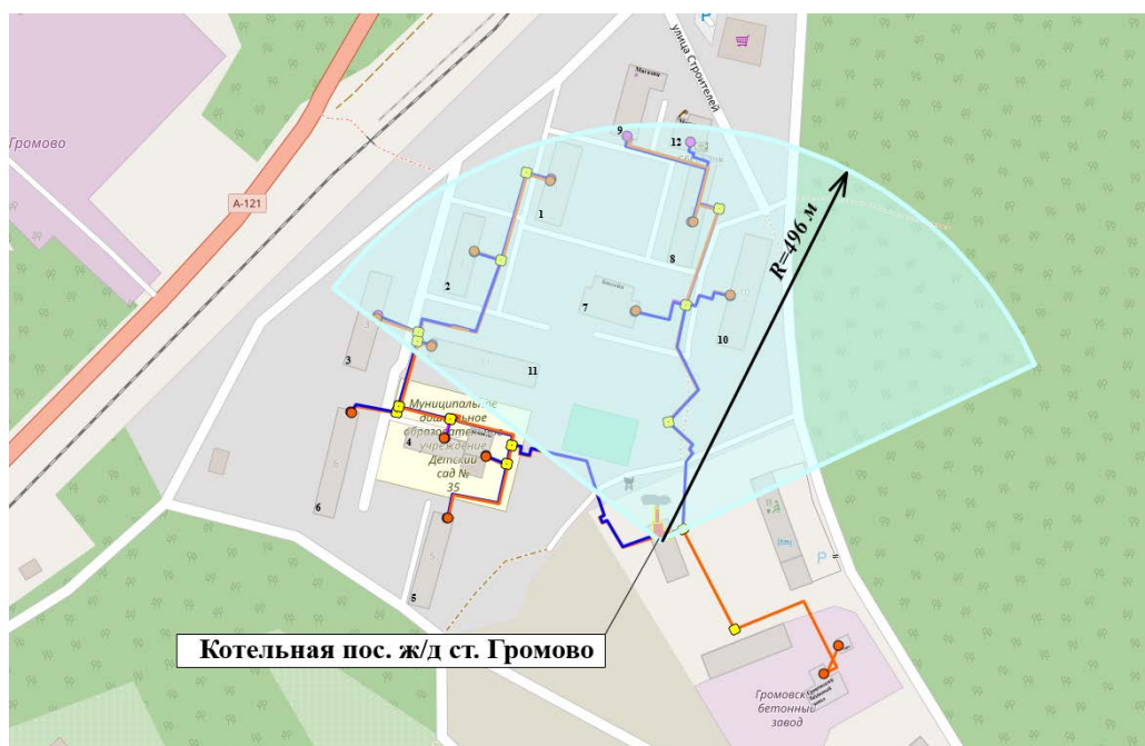
Рисунок 48 Тепловая зона и радиус эффективного теплоснабжения котельной п. Громово
